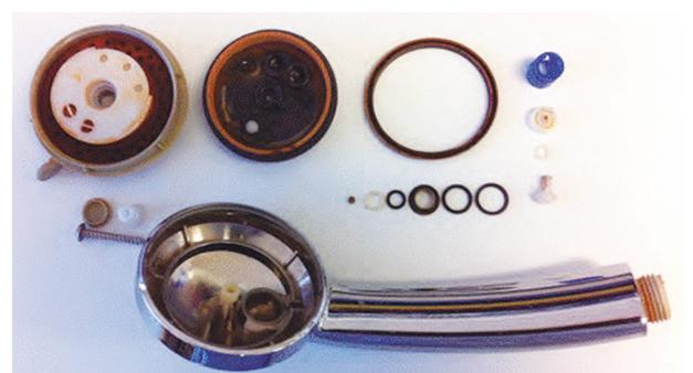
图 1 2015 年,澳大利亚,从非载客商船上拆卸的淋浴喷头显示了多个内部部件,其中包括 7 个 O 形环,它们都与通过的淋浴水相接触
